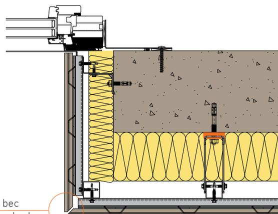
Usinage en bec d'oiseau standard V-Clip (7x7)
