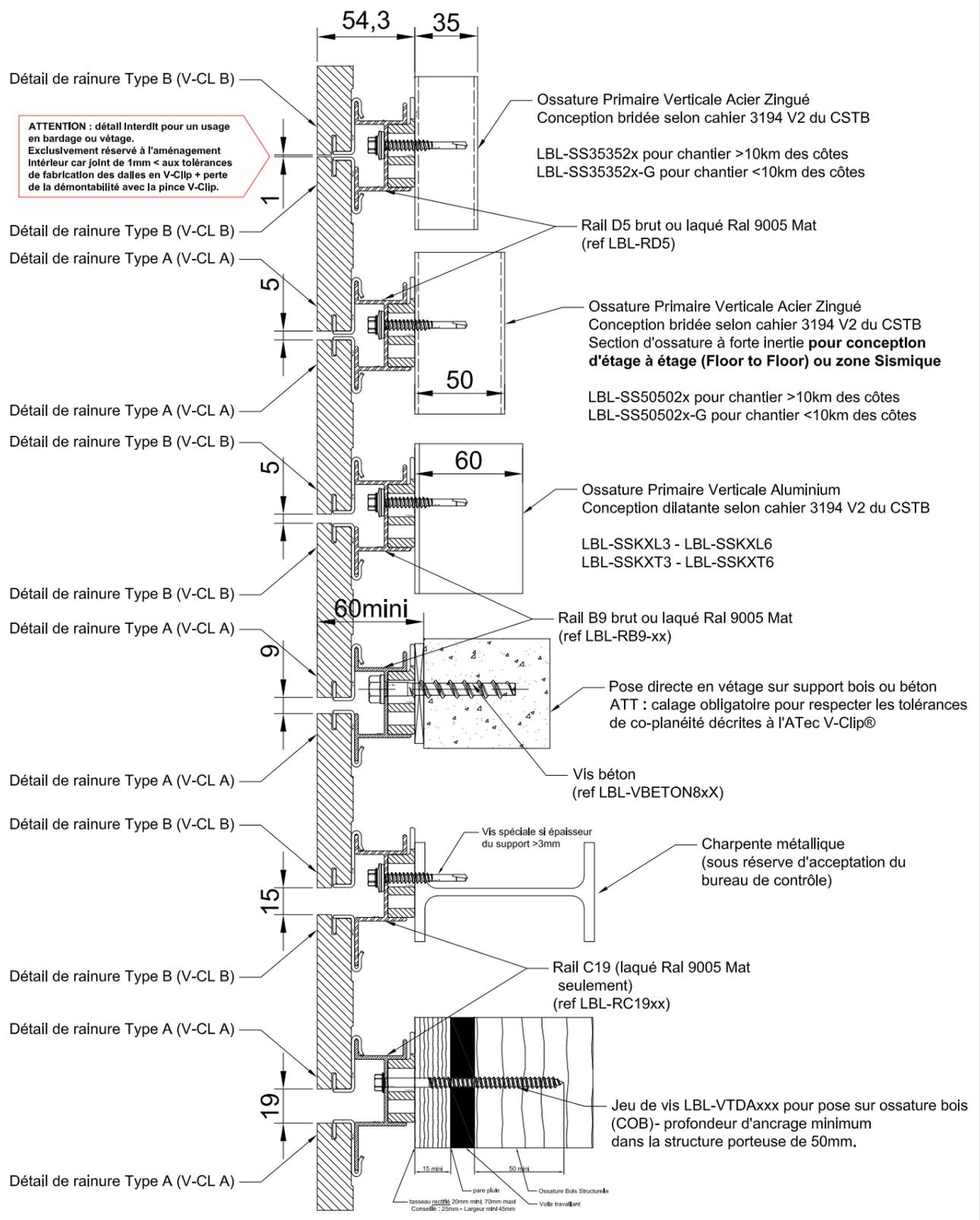
Jeu de rails avec isolateur galvanique (LBL-CPP) compatibles avec sous structures verticales Acier Zingué LBL-SS3535xx ou LBL-SS5050xx (pose possible aussi sur sous structure Alu LBL-SSKXxx ou pose en vêtage béton ou COB)
